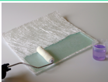
2.PC-6150N をガラスマット にローラーで含浸 ※硬化剤使用
