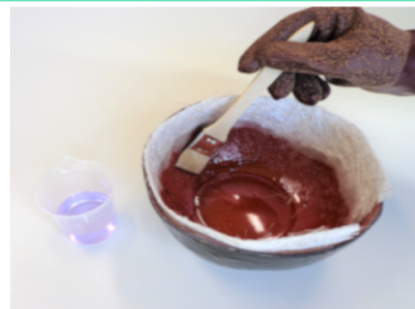
3.PC-6150Nをガラスマットに 刷毛で含浸硬化剤使用
